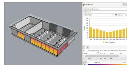
【Radiation Map】(日射量解析)では、年間の日射量を解析します。建物外皮で受熱する日射量の把握や太陽光パネルの設計に有用です。
